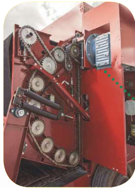
Direktantrieb der Presskammer E-Motor 30 KW
