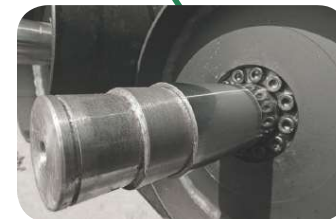
Presskammerwalzen mit durchgehender Welle und austauschbaren Verschleißbuchsen
